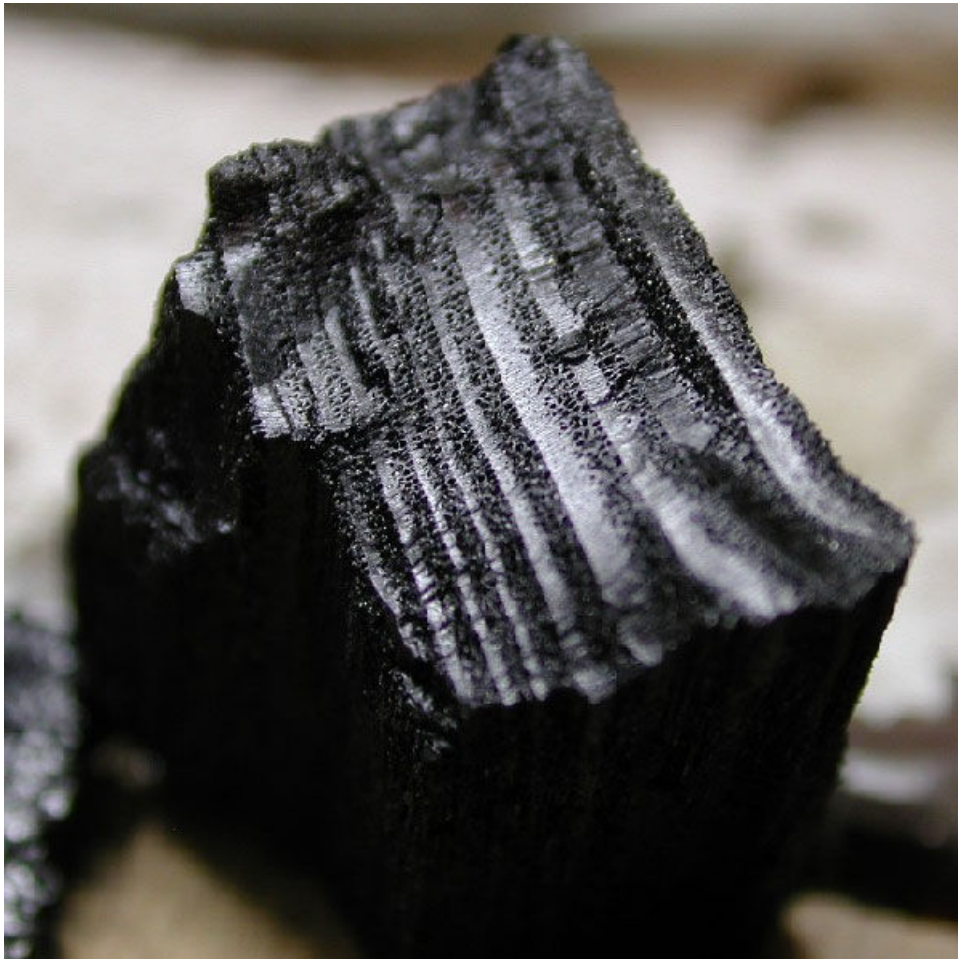
La porosità di un pezzo di carbone di frassino è chiaramente visibile anche ad occhio nudo (foto: Andreas Thomsen)
